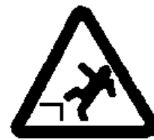
Chute avec dénivellation
